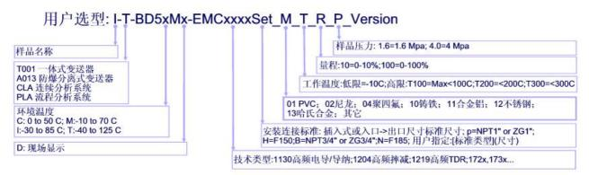
二次表选型: 所有型号的智能变送器都可以直接接任何标准信号二次仪表,组成实用测试系统。注意向变送器提供9-24VDC电源。由于现场原因,有些选型不能带现场显示或键盘操作界面时,建议选择pBD4emc测控器或选择微机软件,以便以后对变送器进行设置标定或选用高级功能。如有特殊要求,请参考 《BD4/5智能变送器/测控器选型资料》.
